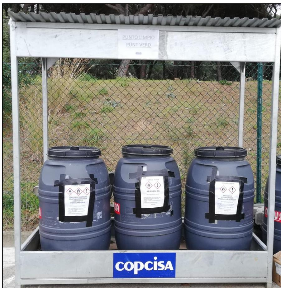
Se han proyectado y fabricado una serie de estructuras reutilizables para el almacenaje de residuos peligrosos.
